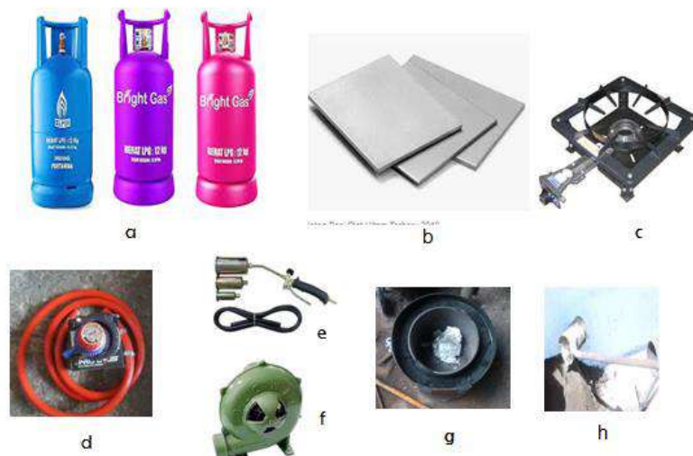
Gambar 3. Peralatan sederhana dalam pengecoran logam antara lain a) Gas LPG, b) besi pelat, c) kompor gas, d) regulator gas tekanan tinggi, e) burner, f) blower, g) kualii pengecoran dan h) penuang
