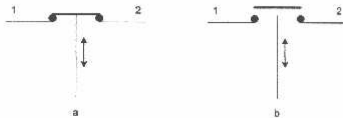
Gambar 3-5 Diagram skematik Tipe (a) NC dan (b) NO Switch
