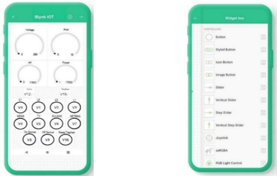
Gambar 12. Konfigurasi Layout pada aplikasi blynk (kiri). Jenis template pada aplikasi Blynk (kanan)
