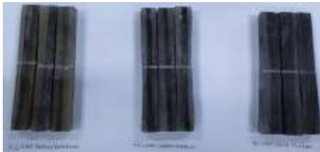
Gambar 4. Spesimen pengujian kekuatan impact
