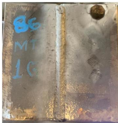
Gambar 2. Hasil Pengelasan Arus 86A dan Jarak Kampuh 4mm
