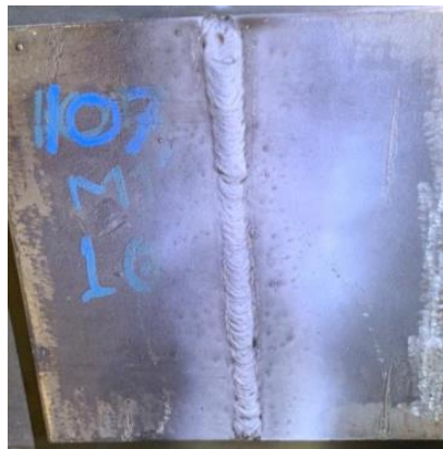
Gambar 4. Hasil Pengelasan Arus 107A dengan Jarak Kampuh 2mm
