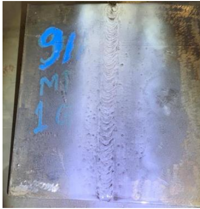
Gambar 3. Hasil Pengelasan Arus 91A dengan Jarak Kampuh 3mm
