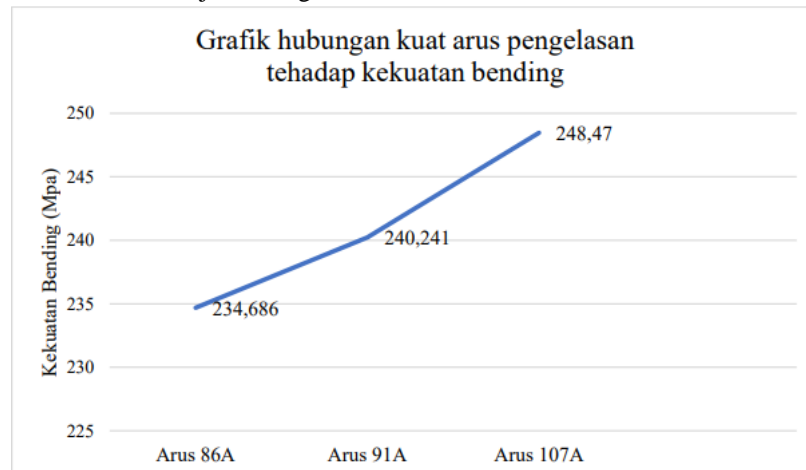
Gambar 8. Grafik Hubungan Kuat Arus Pengelasan Terhadap Kekuatan Bending
