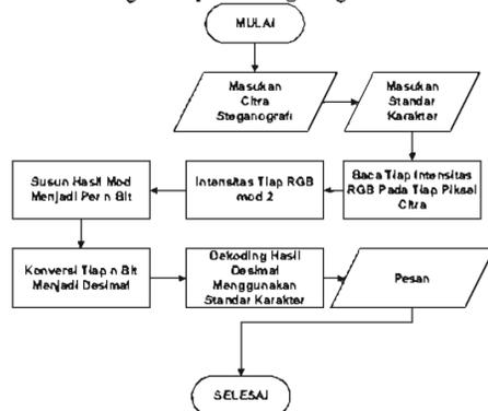
Gambar 5. Diagram alir proses decoding pesan menggunakan LSB
