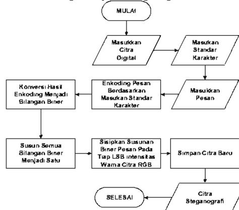
Gambar 4. Diagram alir proses enkoding pesan menggunakan LSB
