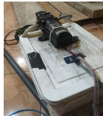
Gambar 4. 2.7Pengujian Pompa Air DC 3V
