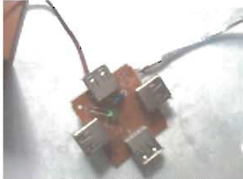
Gambar 9. USB Hub Untuk Menyambungkan Antara Web Cam Dengan Lampu Led
