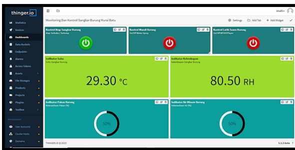
Gambar 4.7 Tampilan Monitoring Dan Kontrol Sangkar Burung Murai Batu Saat Prototype Sudah Berjalan
