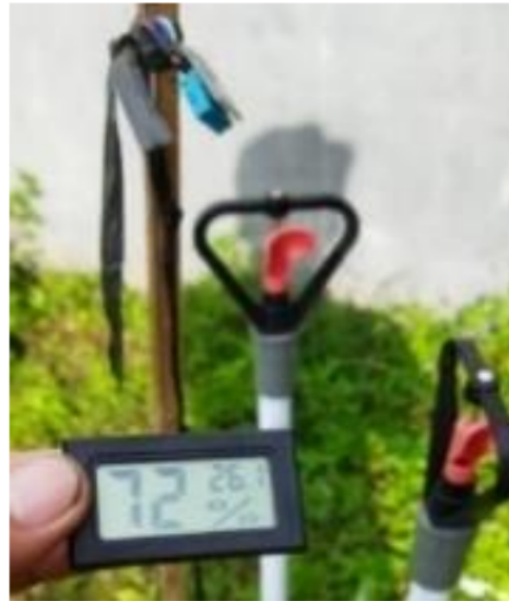
Gambar 16. Pengujian Sensor DHT11
