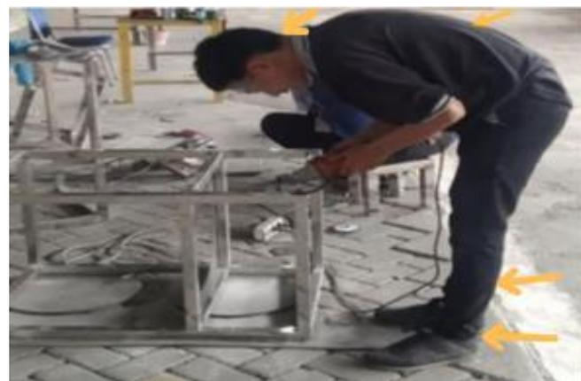
Gambar 1. 2 Posisi Pekerja Membungkuk Pada Proses Pengelasan
