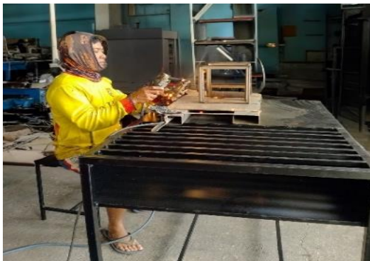
Gambar 10. Implementasi Meja Pada Saat Proses Pengelasan
