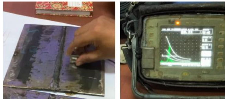
Gambar 4. Proses Uji Ultrasonic Kampuh V
