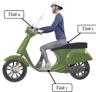
Gambar 4. Titik Pembebanan pada Rangka scooter listrik
