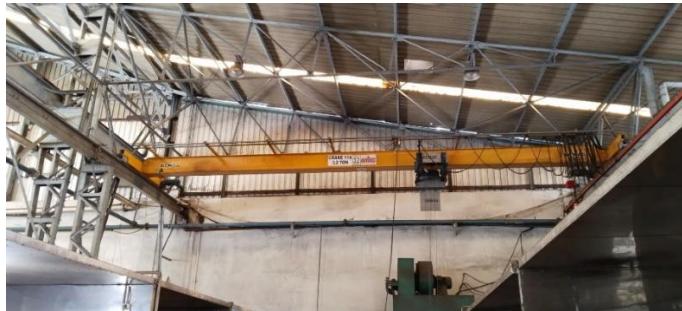
Gambar 1.1 Alat Berat Hoist Crane Sumber : PT INKA (Persero)
