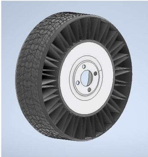
Gambar 2. Ban tanpa udara tipe tweel
