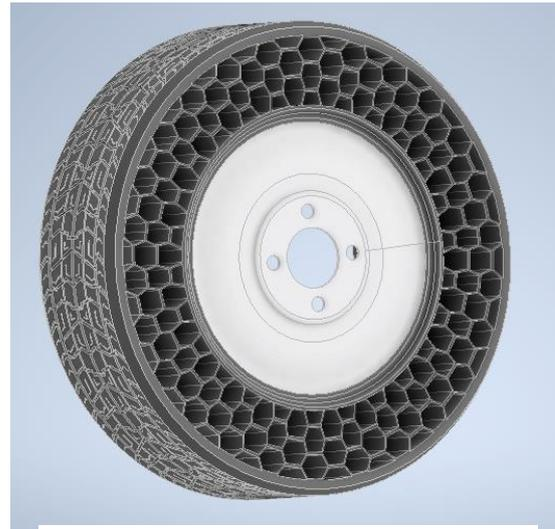
Gambar 3. Ban tanpa udara tipe honeycomb
