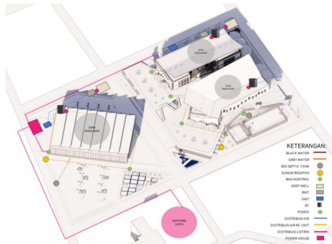
Gambar 14. Sistem Utilitas Tapak Sumber : Analisa Pribadi, 2023
