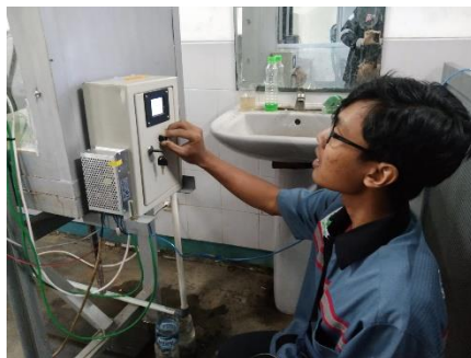
Gambar 3.33 Mengatur Besar Kecilnya Gelombang dan Kecepatan hidrolis pada Control Modul
