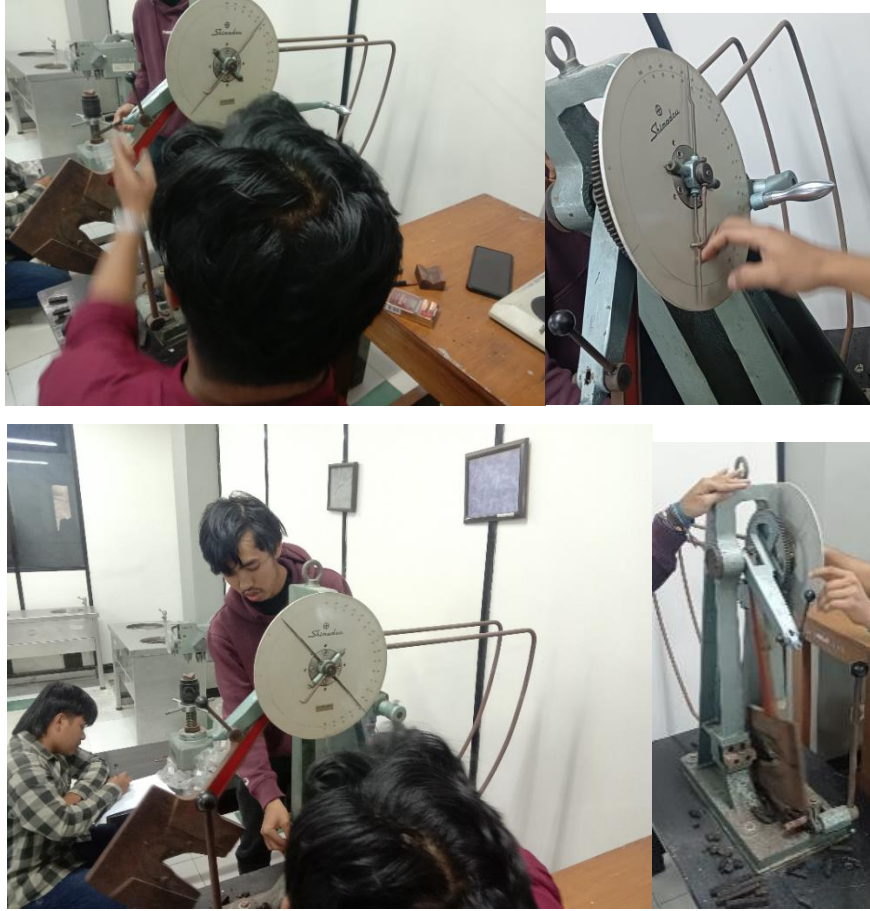
Gambar 9 Proses uji Impact Spesimen Komposit Ecobrick
