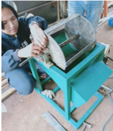
Gambar 4 Pemasangan pisau pencacah
