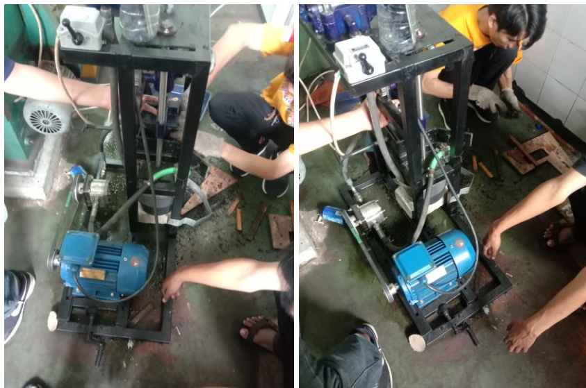
Gambar 8 Proses pengepressan Spesimen Komposit Ecobrick
