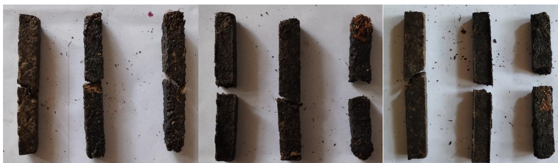
Gambar. 12. Spesimen Pengujian Impact Eco-Brick dari hasil cacahan bilah pisau 4 (kiri), bilah 6 (tengah) dan bilah pisau 8 (kanan)
