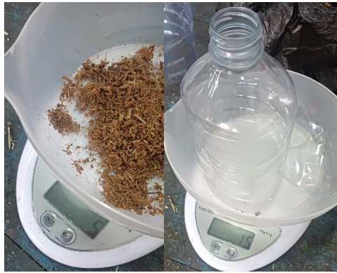
Gambar. 6. Penentuan komposisi serat dengan perekat komposit yang akan dibuat
