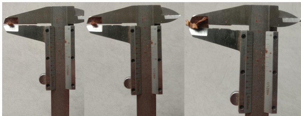
Gambar. 14. Ukuran serat dari yang paling halus 0,1 cm-0,2cm (kiri) dan sedang 0,3cm-0,5 (tengah) sampai yang paling kasar 0,5cm-1cm (kiri)
