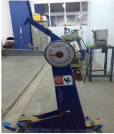
Gambar 3. 19 Alat Uji Impact
