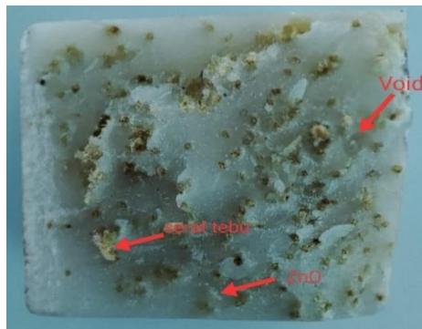
Gambar 4. 5 Permukaan Patahan Uji Impact 5% ZnO & 10% Al 2 O 3
