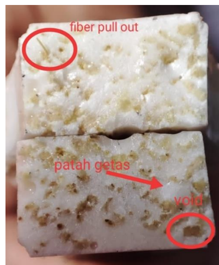
Gambar 4. 1 Permukaan Patahan Uji Tarik 0% ZnO & 10% Al 2 O 3
