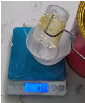
Penuangan resin epoxy
