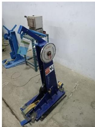
Gambar 2.7 Alat Pengujian Impact Alat pengujian Impact
