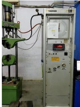
Gambar 2.9 Alat Pengujian Bending
