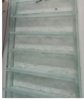
Gambar 3. 4 Cetakan Uji Bending
