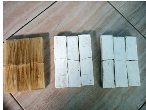
Spesimen hasil uji bending 0%, 5% dan 10% TiO 2
