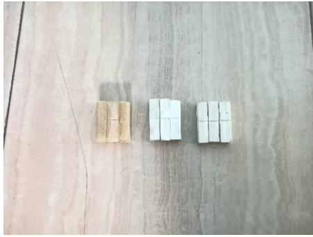
Spesimen uji impact 0%, 5% dan 10% TiO 2
