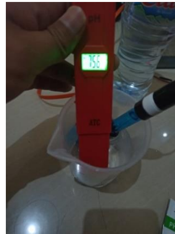
Gambar 9 Pengujian Sensor pH Air Meter Tabel 1 Pengujian Sensor pH air
