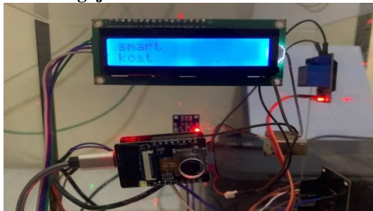
Gambar 12 Pengujian ESP32 Cam Pengujian ESP32 Cam berguna untuk memastikan Kamera berfungsi dengan benar serta mengirimkan notifikasi ke Telegram.
