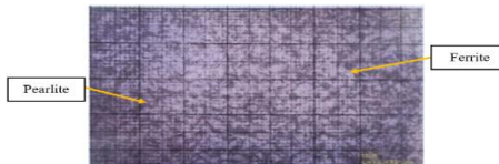
Gambar 18. Struktur Mikro Oli SAE 40 Daerah Weld metal
