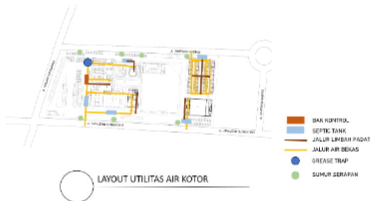
Gambar 6. 7 Infrastruktur Air Kotor Tapak Sumber : Dokumen Pribadi, 2023
