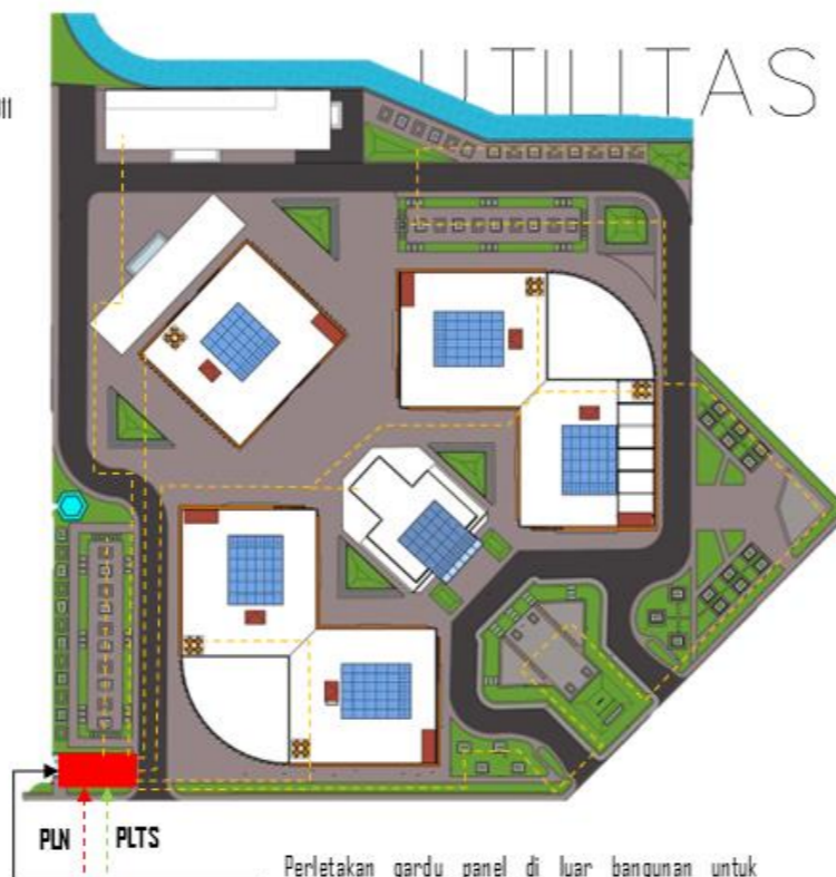
Perletakan gardu panel di luar bangunan untuk memudahkan akses petugas PLN melalui akses servis
