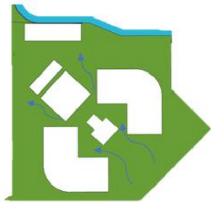
MEMAKSIMALKAN PENGHAWAAN (4) Pemisahan massa bangunan yang dimanfaatkan sebagai sirkulasi pejalan kaki, selain itu penghawaan yang dihasilkan dari pemisahan massa ini lebih optimal melewati celah antar massa bangunan.
