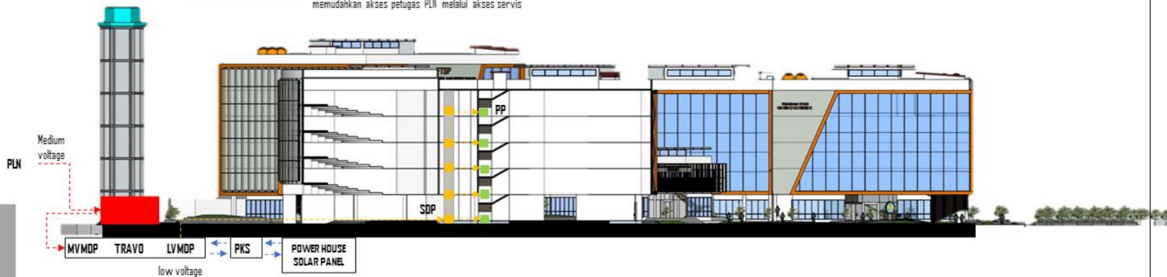
Perletakan gardu panel di luar bangunan untuk memudahkan akses petugas PLN melalui akses servis
