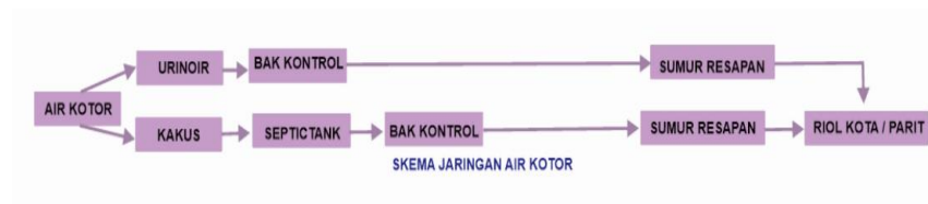
gambar 5.2. konsep utilitas air kotor2
