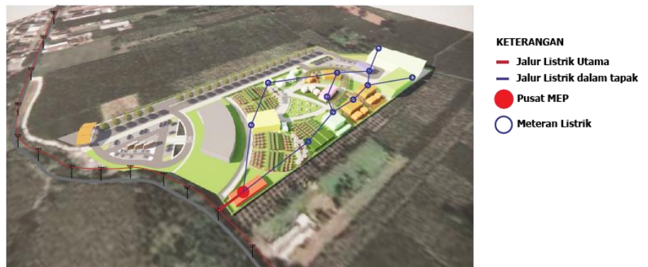
Gambar 12. Skema Elektrikal Sumber : Analisa Pribadi,2023
