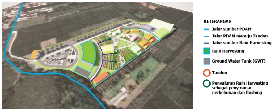
Gambar 10. Skema Air Bersih Sumber : Analisa Pribadi,2023
