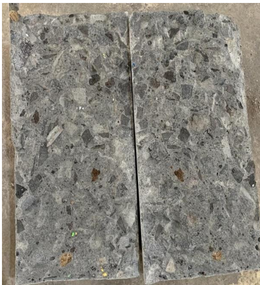
(Hasil Penyebaran Serat Pada Benda Uji Silinder)
