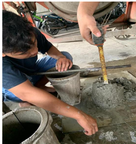
(Pengujian Test Slump Beton)
