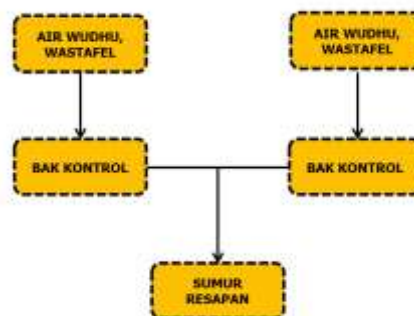
Diagram 4.12 Skema Air Kotor Sumber : Data Pribadi, 2023
