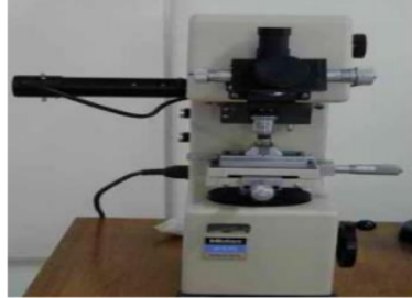
Gambar 2. Alat Uji Kekerasan Vickers
