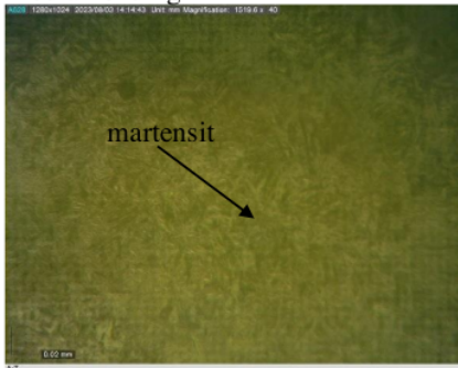
Gambar 7. Hasil Struktur Mikro Baja AISI 4140
