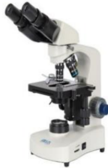
Gambar 3. Alat Uji Struktur Mikro
