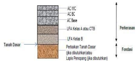
Gambar 2.6 Struktur Perkerasan Lentur (Lalu Lintas Berat) pada Timbunan dan Galian
