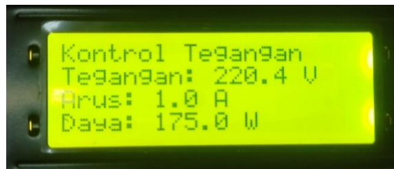
Gambar 4. 14 Tampilan LCD pada Pengujian Beban Induktif
