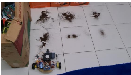
Gambar 4. 8 Pengujian integrasi Raspberry Pi dengan Robot Pembersih Lantai (Tampilan Robot Pembersih Lantai)
