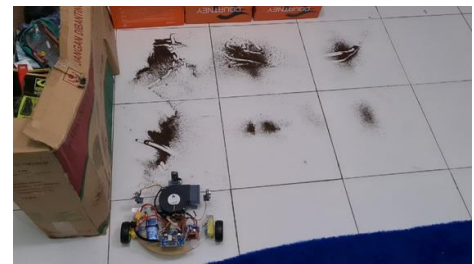
Gambar 4. 10 Pengujian integrasi Raspberry Pi dengan Robot Pembersih Lantai (Tampilan Robot Pembersih Lantai)
