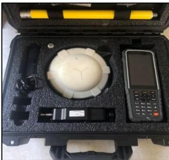
Gambar 3.4 Kelengkapan Alat GPS Comnav T300
