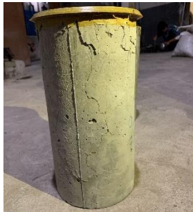
Gambar 2 Pola Retak Beton Pada Pengujian Kuat Tekan
