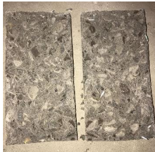
Gambar 3 Pola Retak Beton Pada Pengujian Kuat Tarik Belah
