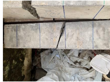
Gambar 4 Benda Uji Mengalami Patah Tengah Berdasarkan pada pengujian balok dapat diamati bahwa pola retak yang terjadi pada balok beton dengan penambahan serat aluminium menghasilkan pola retak lentur. Pola retak yang terbentuk berada pada bentang tengah balok.
