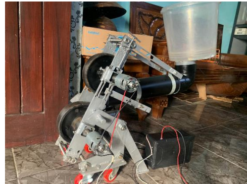
Gambar 1. Kerangka mesin pelontar bola tenis lapangan berbasis mikrokontroler
