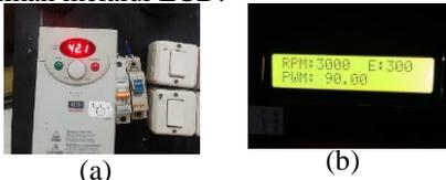
Gambar 3.8 (a) Hasil Frekuensi Kalibrasi VCD Motor AC (b) Tampilan LCD Dari Hasil Kalibrasi Kecepatan Putaran
