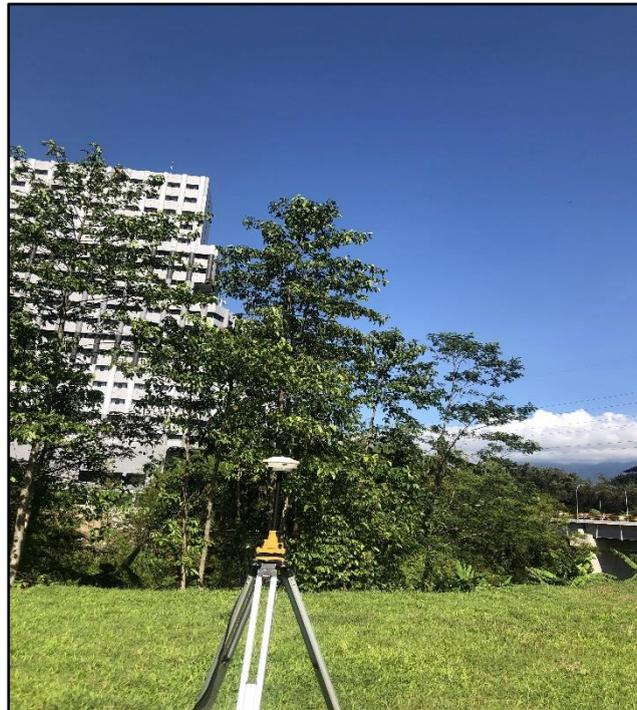
Gambar 3. 4 Pengukuran *Spotheight* Dengan Alat Berdiri Pada Patok GCP
