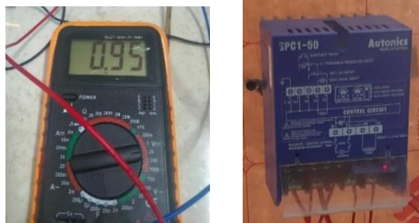
Gambar 4. 9 Hasil tegangan pada triac
