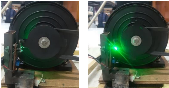
Gambar 4. 6 Ketika pulsa low (kiri) dan ketika pulsa high (kanan)
