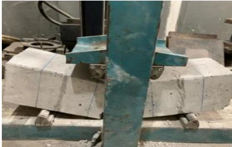
Gambar 4. 3 Pola Patah Kuat Tarik Lentur
