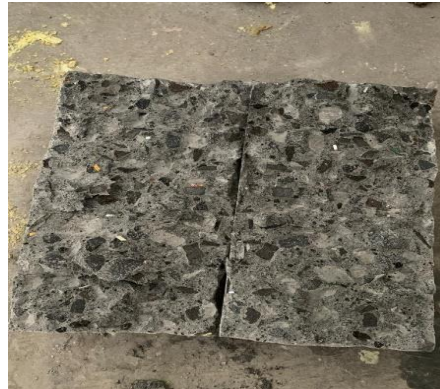
Gambar 4. 2 Pola Retak Tarik Belah
