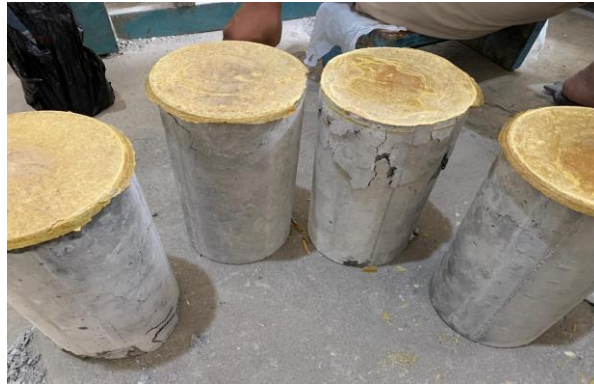
Gambar 4. 1 Pola Retak Kuat Tekan
