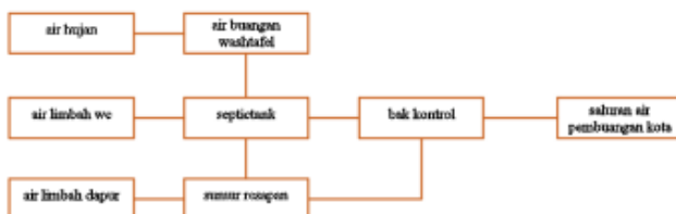
Gambar 8. Utilitas air kotor. Sumber: Analisa Pribadi, 2022
