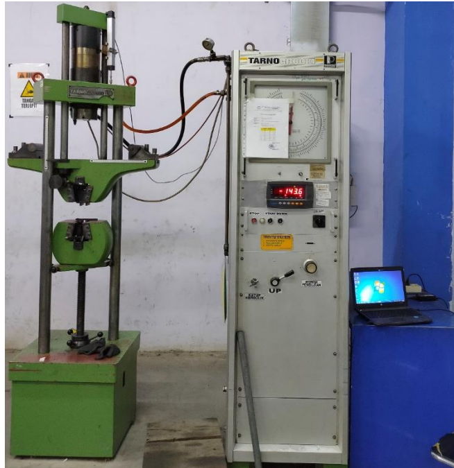
Gambar 3.5 Mesin Uji Tarik (sumber: dokumen pribadi)
