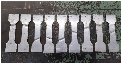
Gambar 4.2 Spesimen aluminium 6061 (sumber: dokumen pribadi)
