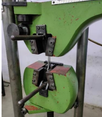
Gambar 4.1 Pengujian tarik material (sumber: dokumen pribadi)
