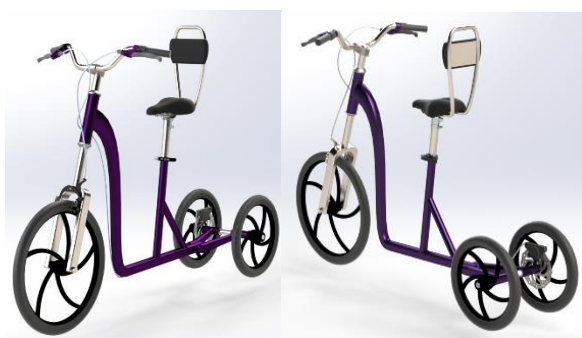
Fig. 8. Rancangan rangka sepeda roda tiga tanpa pedal
